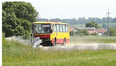
Zkušební náraz TB51 na svodidlo ZMS4-A3/H2.
