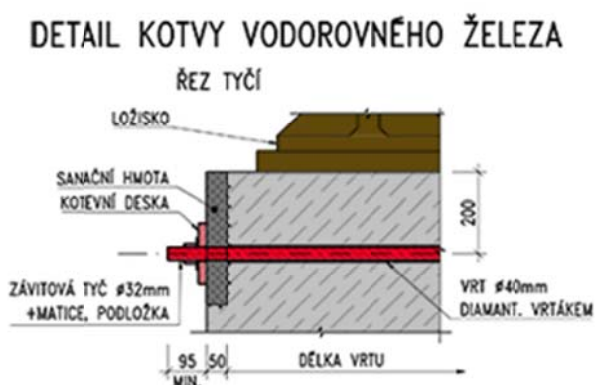
Obr. 3 Boční řez stativem s detailem uchycení a výztužné pruty
